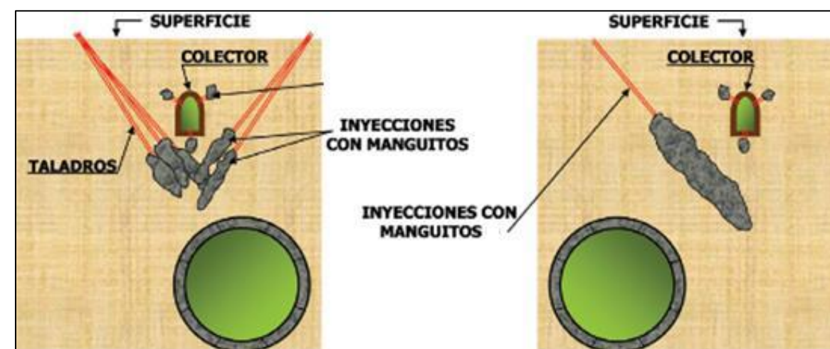
Figura nº 1. Ejemplos de tratamientos de protección para servicios enterrados (adaptado de Oteo, 2015)
